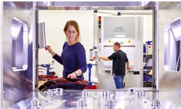
شکل ۴: اتصال چراغ های عقب خودرو با سامانه پرتو لیزر PowerWeld ۳D ۸۰۰۰ شرکت LPKF.
