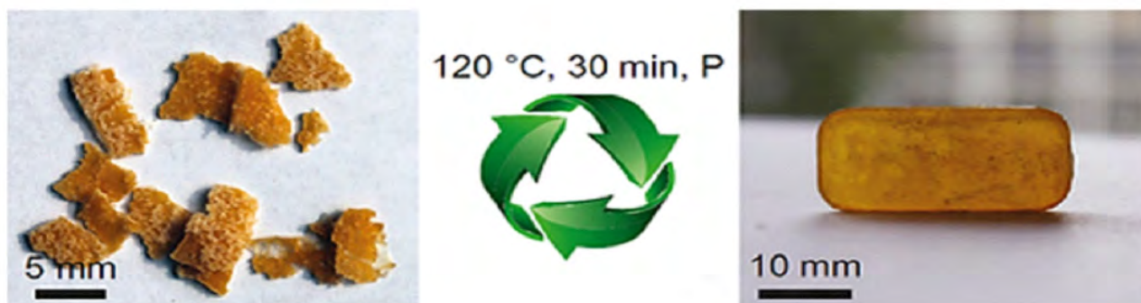
شکل ۶: یک پلی‌بورتان گرماسخت با گروه‌های ۴،۲،۱-تری‌آزولین ۵،۳-دیون بر پایه‌ی (DA) (DA-based) که می‌توان قطعات شکسته شده‌ی آن را طی یک قالب‌گیری در فشار و دمای زیاد بازیافت کرد.
